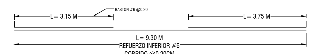
EJEMPLO DE PIEZAS EN LECHO INFERIOR EN DIRECCIÓN LARGA DE FUNDACIÓN ESC. 1:20
